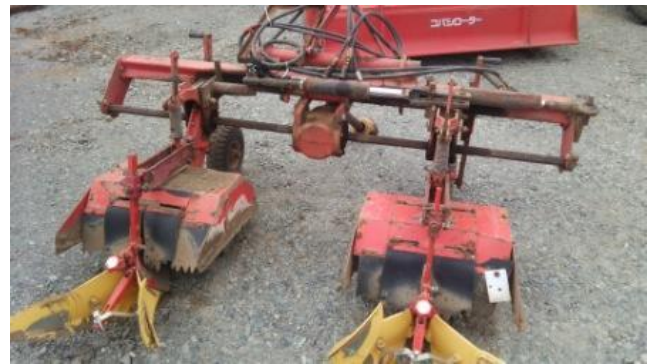
油圧で幅を調整できるよう改良した ロータリーカルチ
