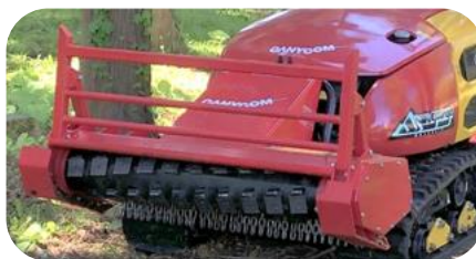
伐根粉碎アタッチメント装着
