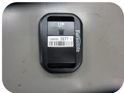
写真1 発情発見装置 (左：センサー、右：センサー装着)
